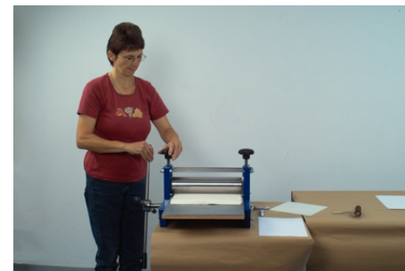
5: Stellen Sie sicher, daß der Spalt zwischen Ober- und Unterwalze parallel ist. Drehen Sie an beiden Sterngriffen gleichmäßig, damit sich der Anpress-Druck gleich über die Platte verteilt.
