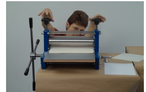
5: Stellen Sie sicher, daß der Spalt zwischen Ober- und Unterwalze parallel ist. Drehen Sie an beiden Sterngriffen gleichmäßig, damit sich der Anpress-Druck gleich über die Platte verteilt.
