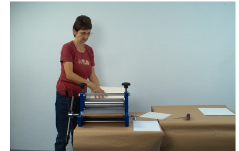
4: Stellen Sie den Abstand der Oberwalze mit Hilfe der Sterngriffe ein. Der Drucktisch mit Druckplatte usw. muß zwischen die Walzen passen.
